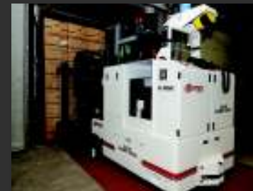
Egemin's ATL-Fahrzeug führt eine komplette Beladung durch
