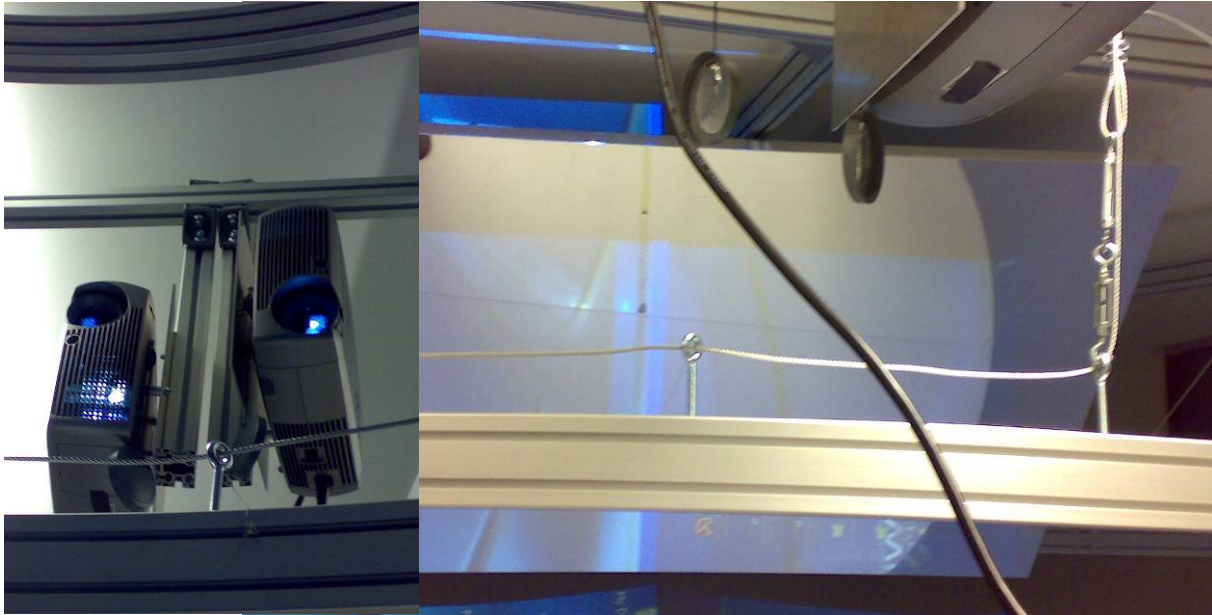
Bild 7) Befestigung der Deckenprojektoren und -spiegel
