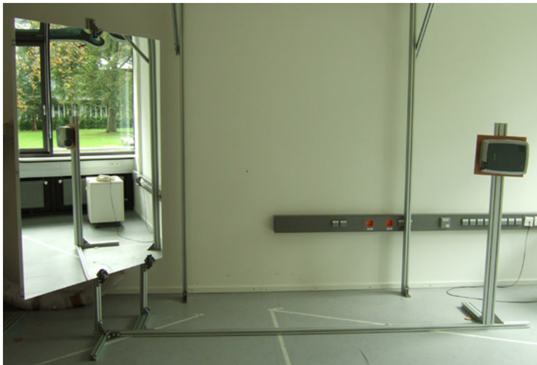
Bild 6) Projektor/Spiegel-Verbindung für die Zylinderprojektion Zu sehen sind die Halterungen für den Aluleichtspiegel und den, um die Längsachse gedrehten, Projektor. Um den Projektionsabstand zu fixieren, wird eine weitere Stange aus Aluminiumprofil verwendet.
